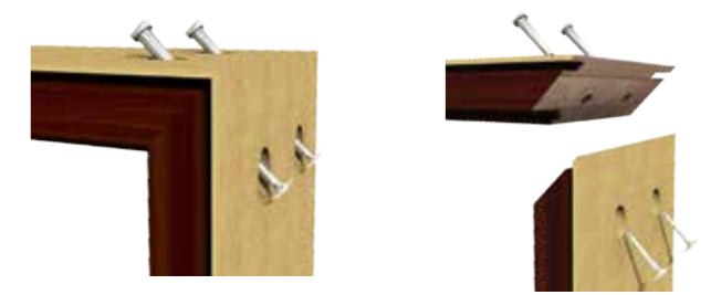
45° KASA BİRLEŞİM DETAYI 45° FRAME JOINT
